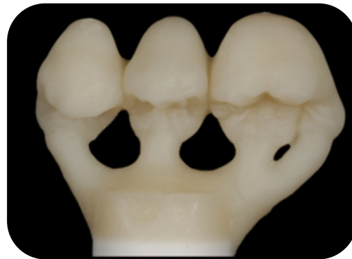
Molaren sollte man mit zwei Gusskanälen anstiften
