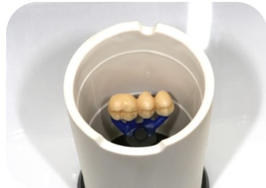
Beispiel eines optimalen Winkels beim Anstiften von Brücken.
