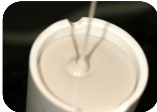
Die Einbettmasse wird bis zwischen dem oberen Innenring und dem Rand aufgefüllt
