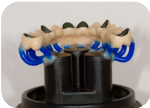
Alles Seitenzähne sollten von bukkal und von oral angestiftet werden
